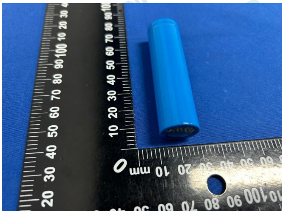
Photo 4 Internal Cell 内部电芯
